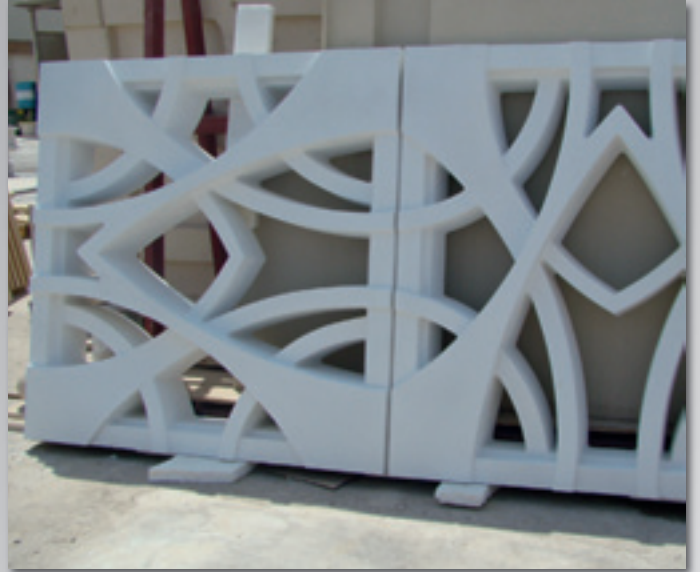
Éléments en béton de claustras terminés
