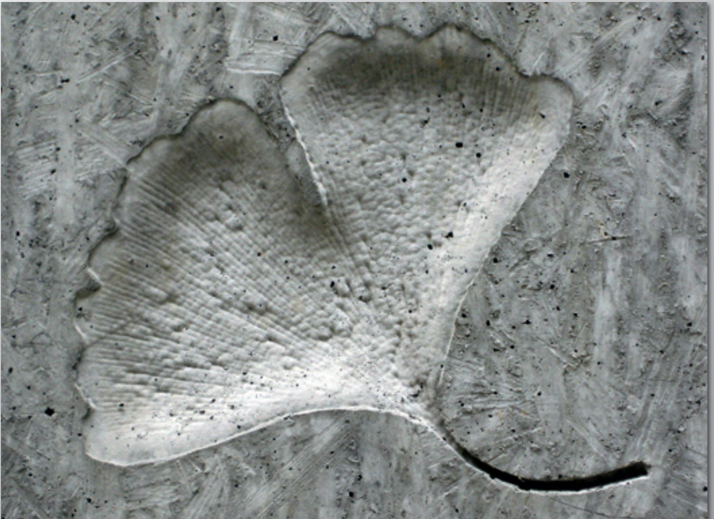
Feuille de ginkgo moulée avec l'élastomère PUR - relief en béton
