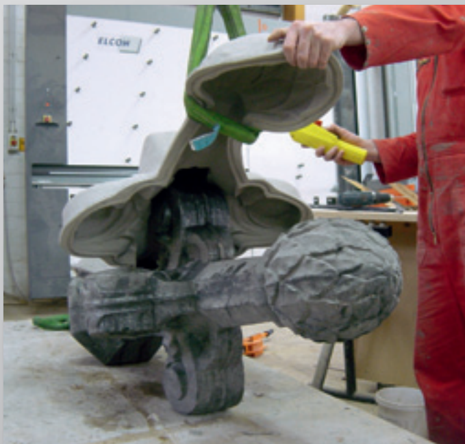
Démoulage d'un moule à membrane en 2 parties composé d'élastomère PUR
