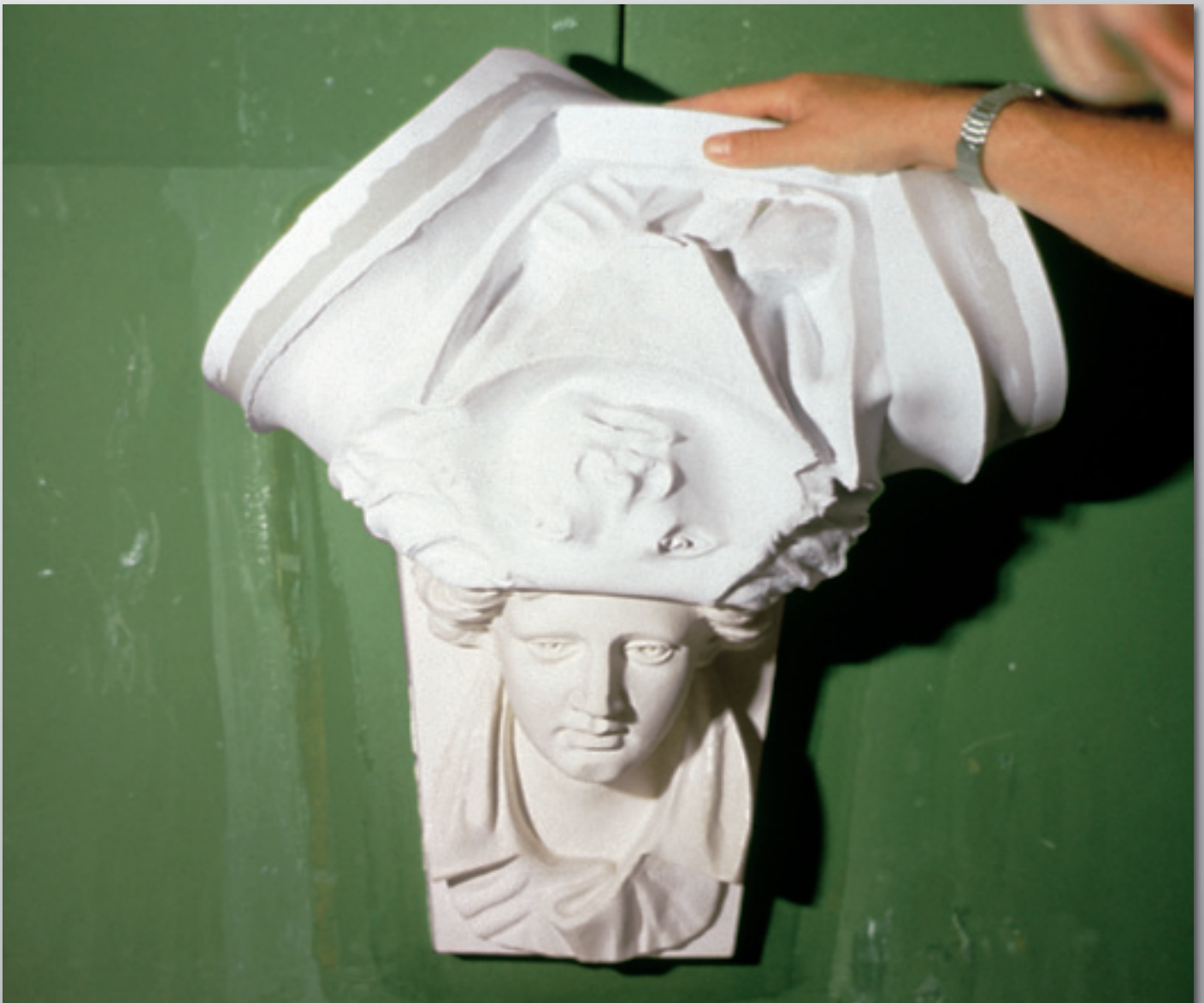
Démoulage d'un moule en bateau en une partie composé d'élastomère SI
