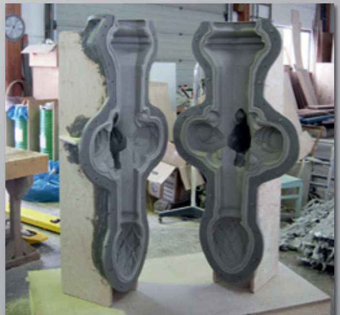
Moule à membrane en 2 parties avec chapes supports
