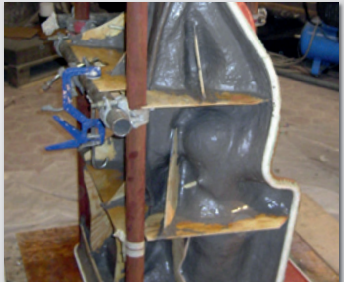
16 | Support et renfort de la première moitié de moule
