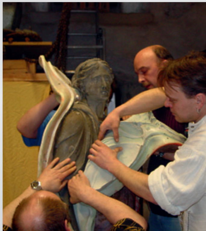
25 | Retrait de la membrane en silicone de la reproduction, en la retournant
