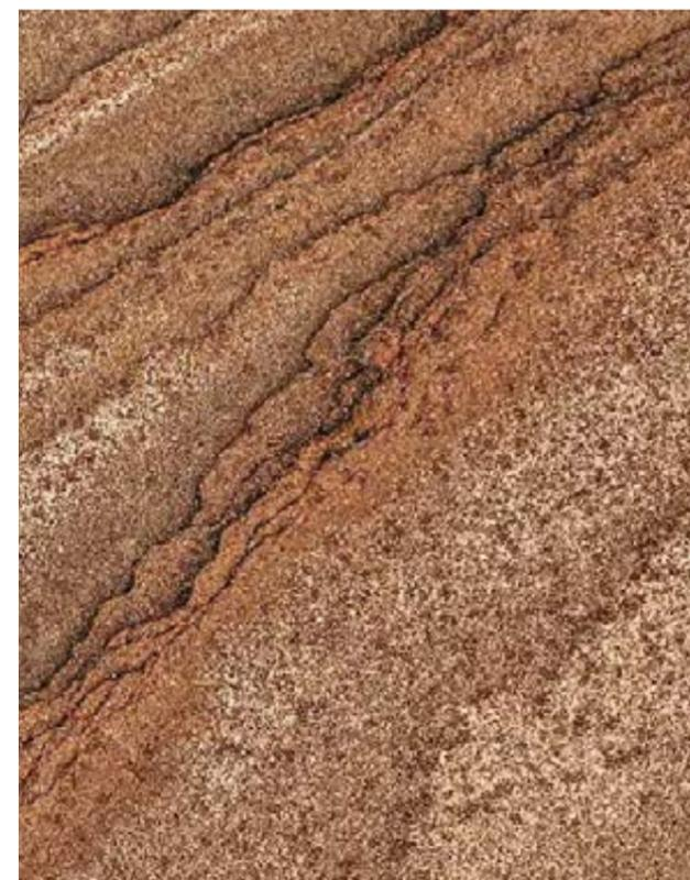
STRATA, qui signifie couches en latin, se caractérise par les propriétés esthétiques et structurelles du béton damé. L'aspect caractéristique est obtenu par la compression et la superposition des différentes couches de béton.
